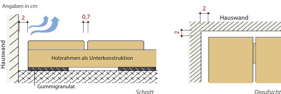
Hinterlüftung mit Mähkante Randstein & Unterbau mit Pflasterstein
