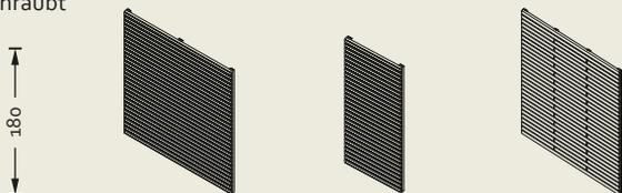
Einzelne Rhombusleisten 23/56 mm, keilgezinkt Lagerlänge 6 m
