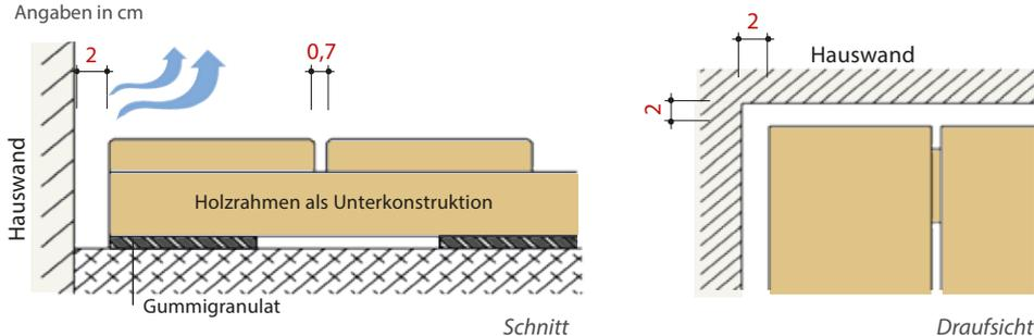
Hinterlüftung mit Mähkante Randstein & Unterbau mit Pflasterstein & Längsstoß
