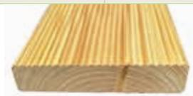
**Empfehlung: Unterkonstruktion mit ca. 40 - 50 cm Abstand montieren. Wir empfehlen die Behandlung der Oberfläche und der Kopfenden mit Holzgrundierung. Befestigung: mit Edelstahl-Schrauben.**
